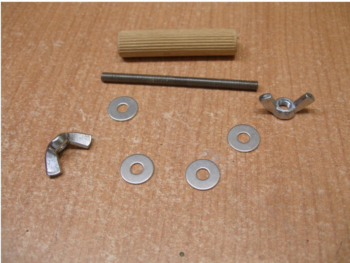
Inicialmente el rodillo de presión estaba constituido por un tubillón de madera estriado al que se le había practicado un taladro. Un trozo de varilla roscada, que se deslizaba por el taladro del tubillón, cuatro arandelas y dos palomillas de sujeción.
