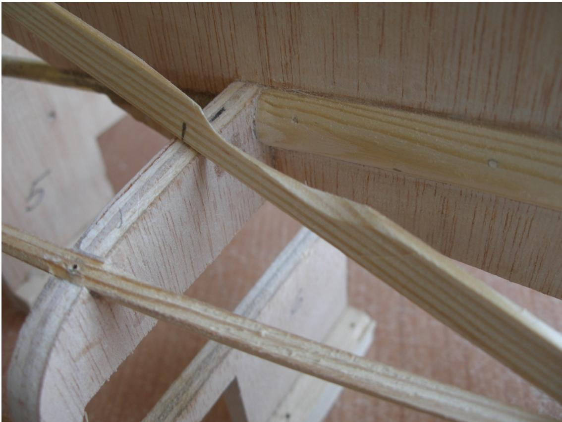
Esta doble curvatura, debe estar dimensionada de manera que ajuste lo más posible con el “**hinchamiento**” del codaste que forman las dos medias cañas que hemos colocado como refuerzo de la quilla. El ajuste, lo más preciso posible, debe ser doble, por un lado por la parte interior del “**hinchamiento**” y por el otro por la parte exterior.
