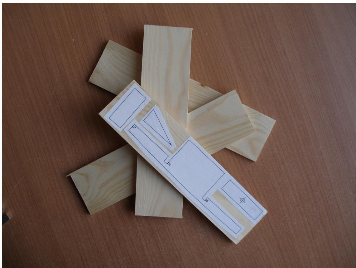
Una vez recortadas las cinco piezas que conforman la caja de la orza pegaremos el rectángulo y el triángulo sobre uno de los laterales. Debemos tener cuidado de hacerlo en la posición debida que nos determina el perfil que le hemos dado a la orza.
