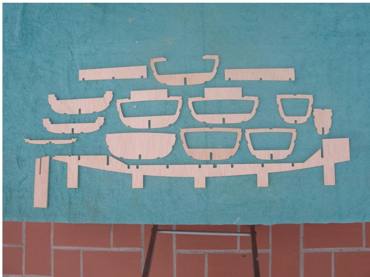
En esta imagen podemos ver todas las piezas cortadas y desprendidas del tablero. Obsérvese la perfección del corte y la exactitud de las medidas y encastres.
