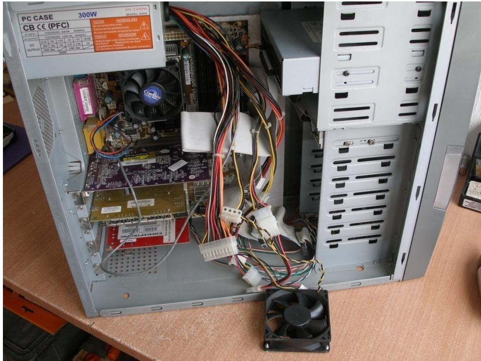
Algunos ordenadores incorporan en su parte superior un ventilador para la refrigeración general de la caja que posiblemente nos estorbe para sacar la fuente de alimentación, si es así, desmontaremos el ventilador que va sujetado por cuatro tornillos.
