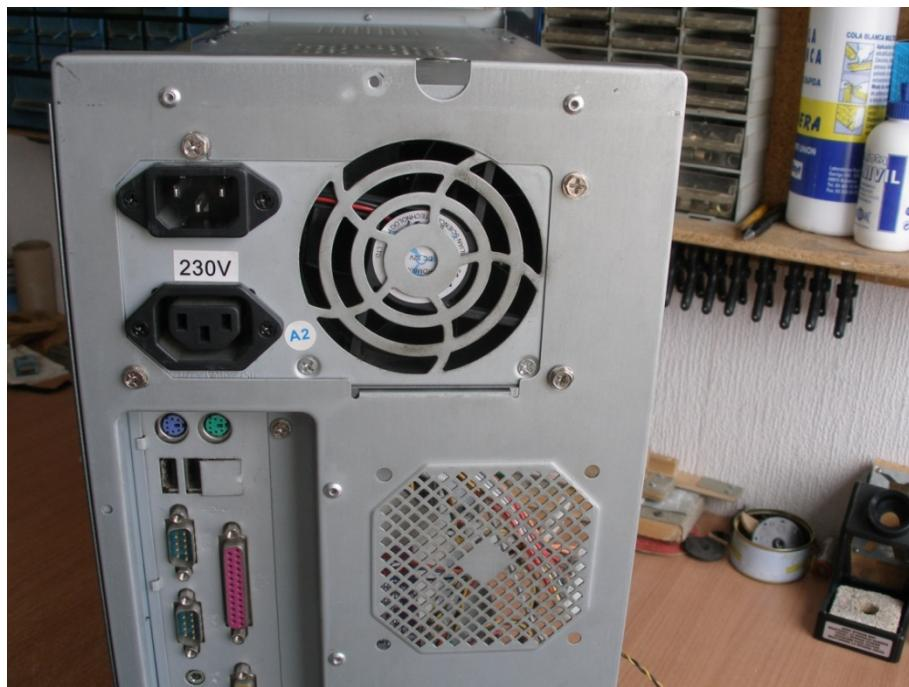
Seguidamente y por la parte posterior del ordenador desatornillaremos, también, los cuatro tornillos que sujetan la fuente al chasis. Tras lo cual ya podemos extraer nuestra fuente de alimentación.
