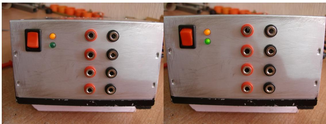
En la imagen de la izquierda el cable de alimentación está conectado a la red eléctrica y a la fuente. El interruptor está en la posición de apagado, pero por el hecho de tratarse de una fuente con tecnología ATX, se está generando una corriente de 5V y 1A. que alimenta el Led de color Rojo.
