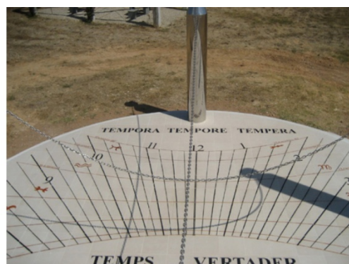
VISTA PARCIAL DE LA MALLA DE LINEAS HORARIAS Y DE DECLINACIÓN. LA INTERSECCIÓN DE LAS SOMBRAS DE LAS CADENAS MARCA LAS 10h 5' DEL PRIMERO DE AGOSTO EN TIEMPO VERDADERO
