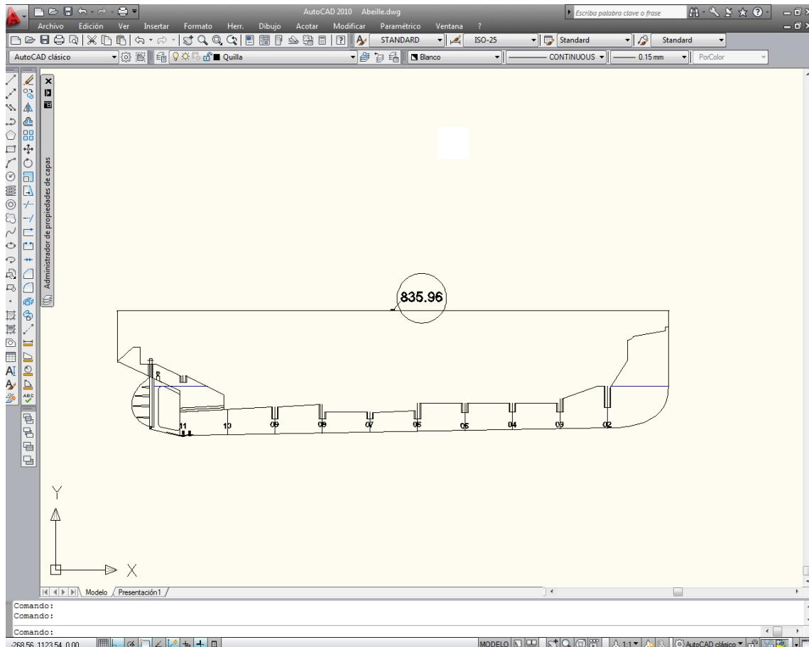
En la imagen superior vemos la quilla, con el timón y el codaste del “**Abeille**” que tiene una eslora de 835,96 milímetros, como vemos ampliado en el círculo de la línea de acotación. La sistemática consiste en dividir, en este caso, la quilla en partes que puedan ser contenidas en un “**A4**”. En el caso concreto del “**Abeille**” necesitaremos cuatro hojas para la quilla más una para el timón y el codaste, es decir en total cinco hojas.
