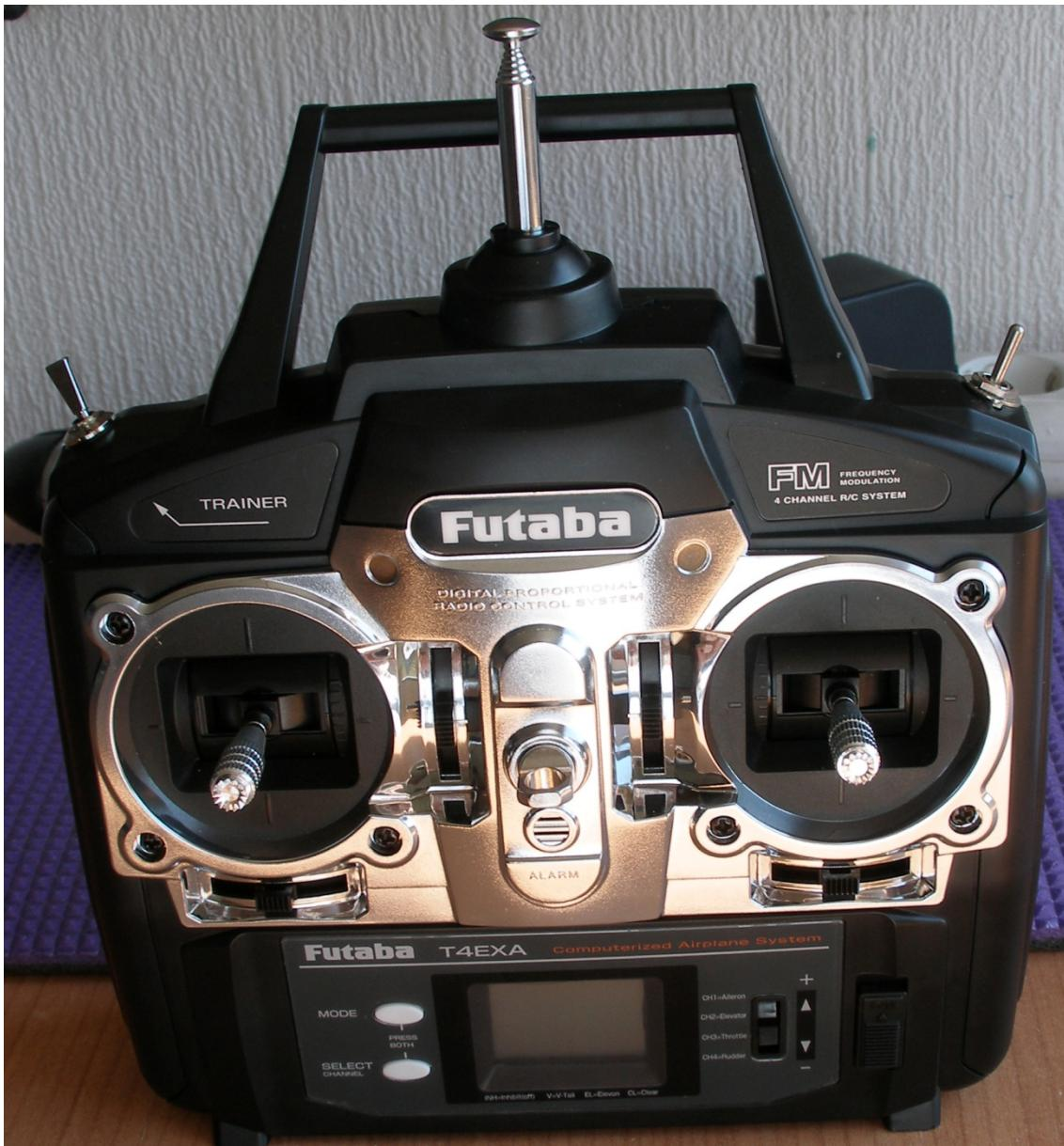
¿Para qué sirve un canal todo o nada? Pues, para extraer un tren de aterrizaje retráctil, accionar una bomba de agua o una bocina, disparar una máquina fotográfica, poner en marcha un motor eléctrico, encender o apagar unas luces o mover la torreta de los cañones de nuestro crucero o arriar y levar anclas o velas.
