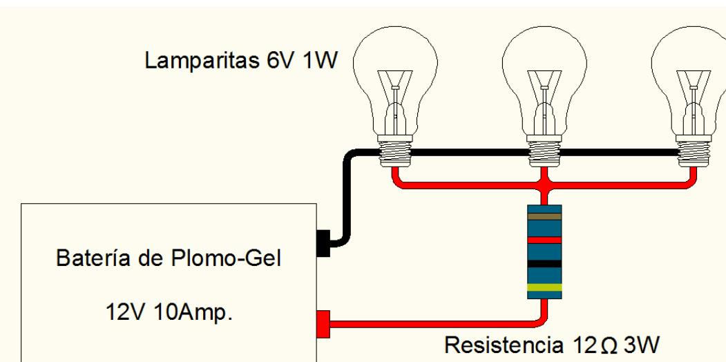
Esquema de conexión en serie con una resistencia para las tres lámparas
