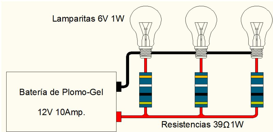
Esquema de conexión en paralelo con una resistencia por lámpara
